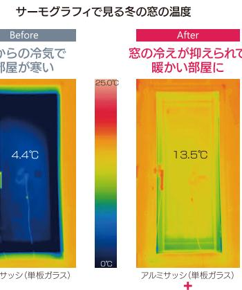
[サーモグラフィ撮影条件] 室内温度 20.0°C / 室外温度 -10.0°C YKK AP 値段検証センター
