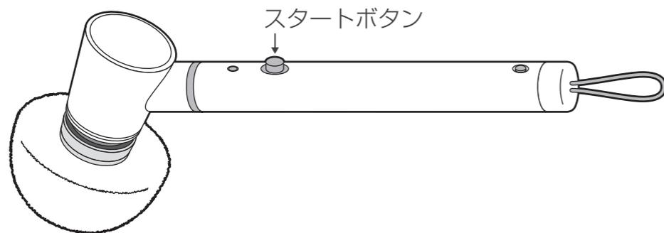
スタートボタンを押すとすぐにブラシが回転を始めます。ブラシに水分が付いた状態で回転させると、遠心力で周囲に水が飛び散りますので注意してください。
