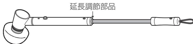
延長状態にするためには、付属の延長パイプを使用します。ハンディ状態から末端部品をロックボタンを押しながら抜き出し、延長パイプのロックボタンを押しながら本体に挿し込んでください。
