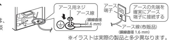
**ご注意** 水道管やガス管、電話線のアースや避雷針には接続しないでください。水道管やガス管に接続すると感電や爆発のおそれがあります。また、電話線や避雷針に接続した場合、落雷のとき大変危険です。
