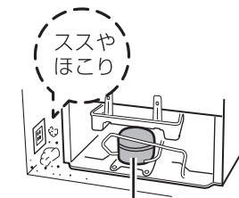
圧縮機(コンプレッサー)
