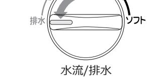
水流/排水切換を「排水」に合わせ排水します。
