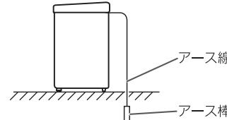
アース工事は法令により電気工事士による D 種接地工事が必要です。
