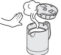
●空だき防止装置が作動したときの処置方法
