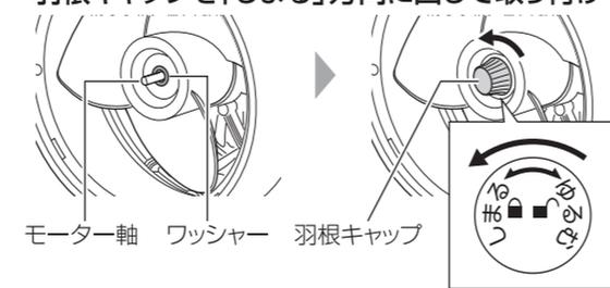
**3 前ガードを前ガードユニットに取り付け、「
