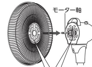
③ 締め付けリングを「
