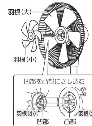
③ 羽根を押さえながら、羽根キャップを「
