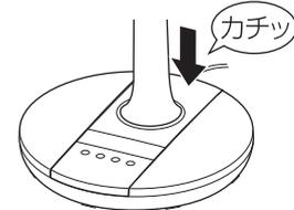
④ 固定リングを「
