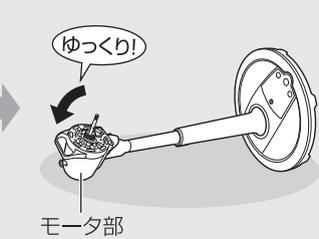
3 ベース底部の固定リングを取りはずし、本体後部の突起(2カ所)をベースから取りはずす
