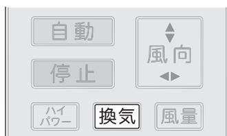
1 自動運転またはいずれかの運転モードで運転中に **換気** を押して、併用換気運転を設定する
