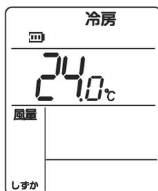
1 運転状態で **しずか** を押して、「しずか」モードを設定する
