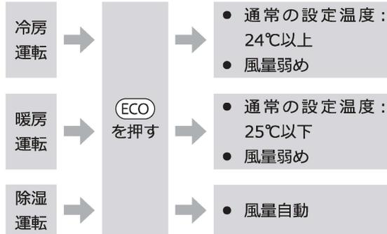
1 冷房・暖房・除湿いずれかの運転中に **ECO** を押して、「ECO」モードにする
