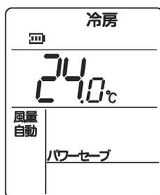
1 運転状態で **パワーセーブ** を 2 秒以上長押しして、「パワーセーブ」モードを設定する
