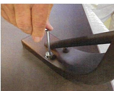
②付属の六角レンチを用いて締め付けます。
