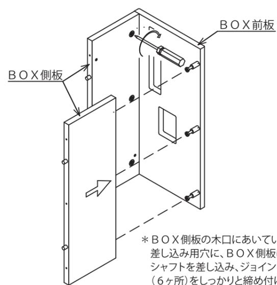
\* BOX側板の木口にあいているシャフト差し込み用穴に、BOX側板に取り付けたシャフトを差し込み、ジョイント金具(6ヶ所)をしっかり締め付ける。
