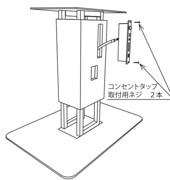
8 支柱の配線止め金具2箇所と付属のコードおさえ1個でコンセントタップの電源コードを固定する。
