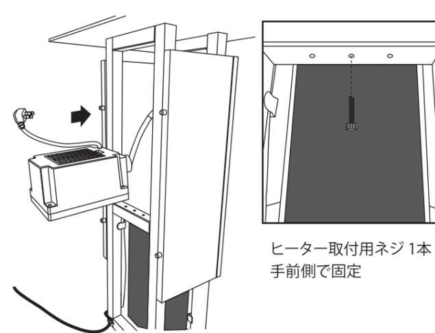
11 ヒーターの電源コードをコンセントタップ背面のコンセント口に差し込む。
