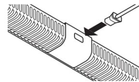
4 「コントローラー」の電源コードにたるみが無いように付属の「コード押さえ」をお好みの位置に貼り付けて使用してください。
