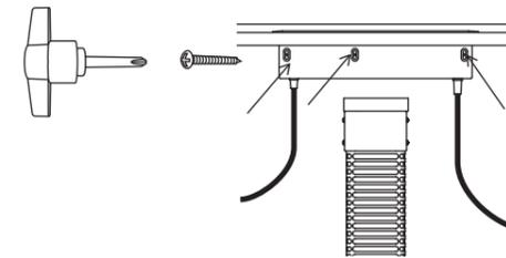
3 コントローラーの器具用差込プラグをヒーターユニットに確実に奥まで差し込み、たるんだコードは「座卓」の内側にあるコードフックに掛けてください。
