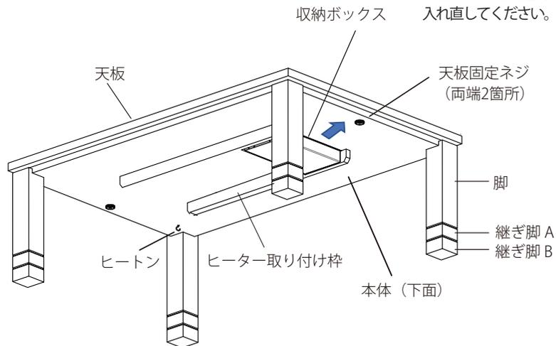
矢印のほうへ収納ボックスの底を手でおし引いて取り出せます。再度収納する場合はフレームの溝に入れ直してください。
