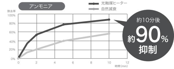
※試験方法: 30L密閉BOXを使用し、LED 8個、電流100mA、光触媒100×40mm、触媒距離20mmでのニオイ抑制結果
