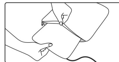
②ヒーターシートとコントローラー付き専用USBケーブルを接続して、
