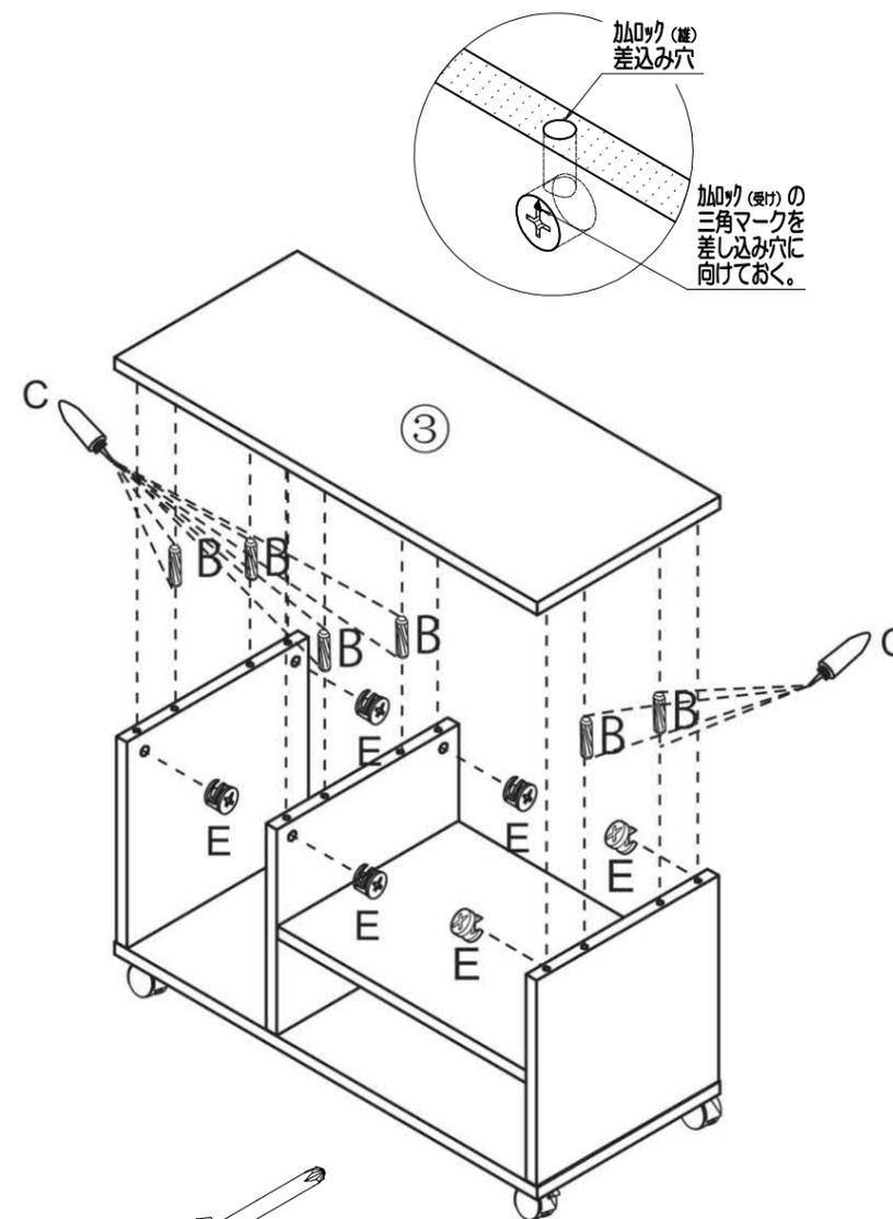
**注意** カムロック (受け) の締め付けをする際、必ず90度から180度の範囲で締め付けてください。無理に回すと破損の原因となりますのでご注意ください。
