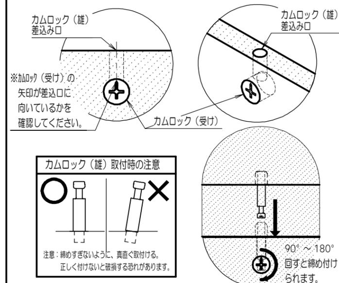
⚠ カムロック(受け)の締め付けをする際、必ず90度から180度の範囲で締め付けてください。無理に回すと破損の原因となりますのでご注意ください。
