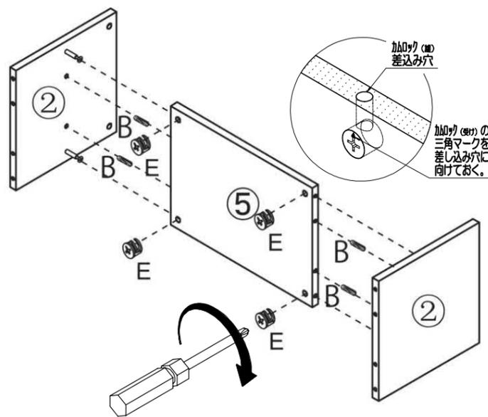
**注意** カムロック (受け) の締め付けをする際、必ず90度から180度の範囲で締め付けてください。無理に回すと破損の原因となりますのでご注意ください。
