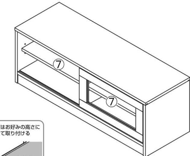
※可動棚は3段可変できます。搭載機器等により最適な位置をお選びください。
