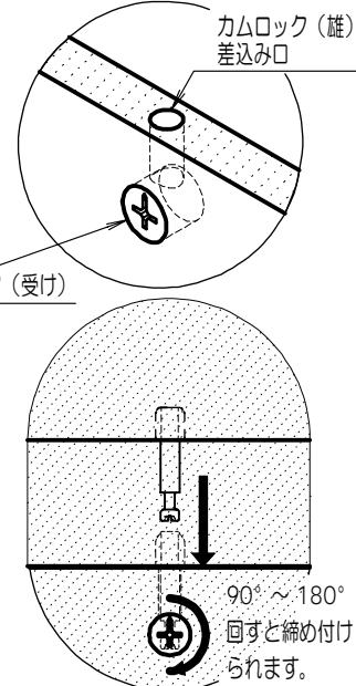
⚠️ カムロック(受け)の締め付けをする際、必ず90度から180度の範囲で締め付けてください。
