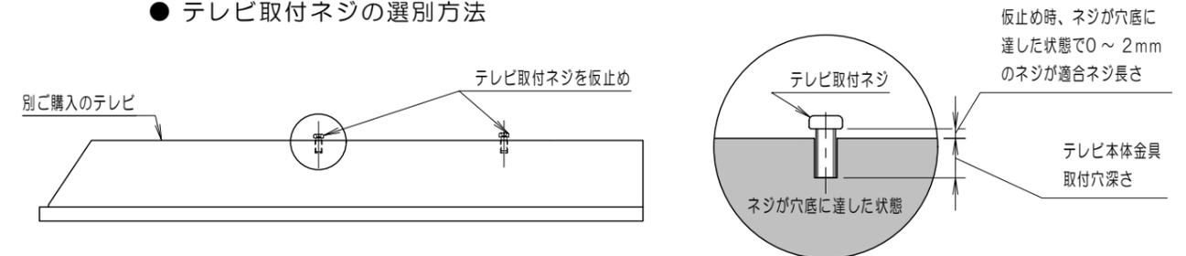
テレビ本体にネジを仮止めし、上図の寸法（0～2mm）に適合したネジをご使用ください。
