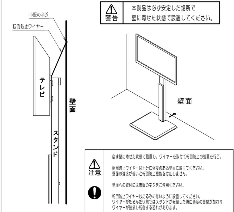
**!** 本製品は必ず安定した場所で壁に寄せた状態で設置してください。
