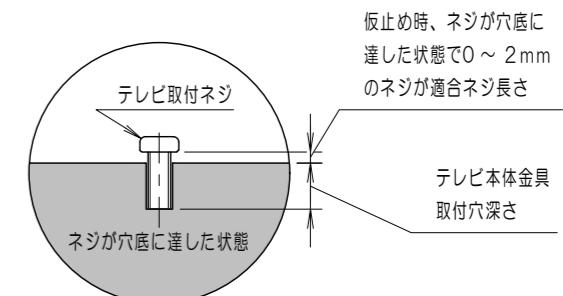
テレビ本体にネジを仮止めし、上図の寸法(0~2mm)に適合したネジをご使用ください。
