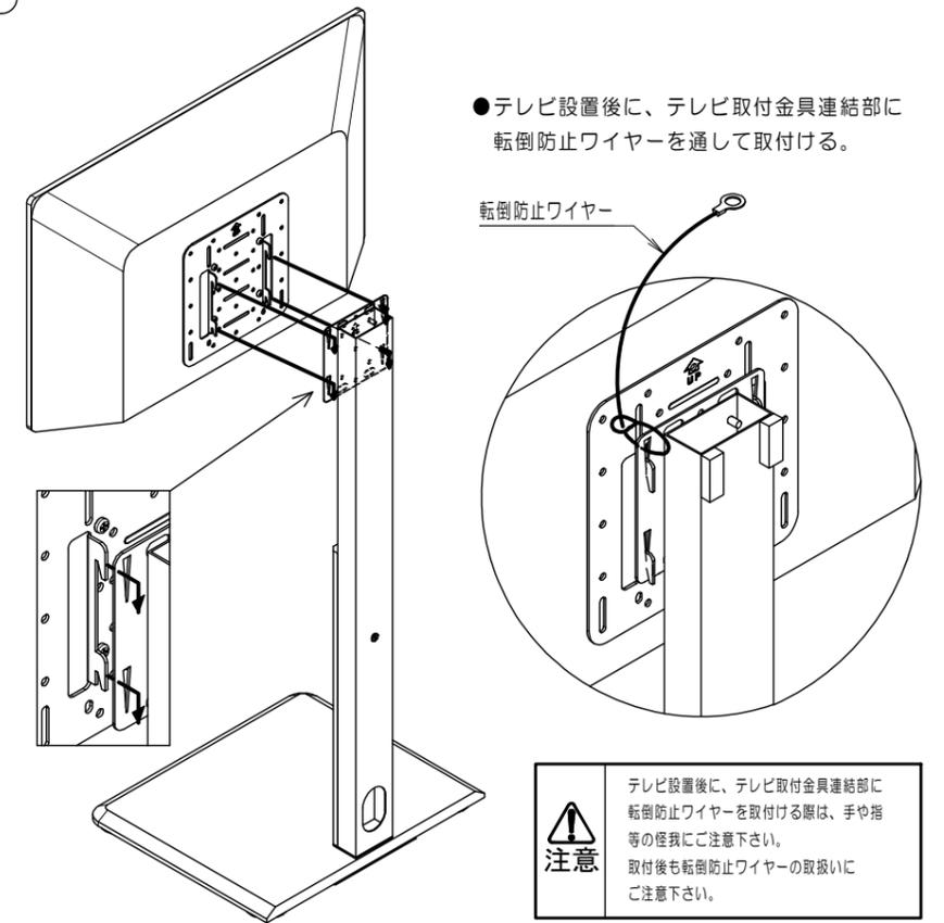
●テレビ設置後に、テレビ取付金具連結部に転倒防止ワイヤーを通して取付ける。
