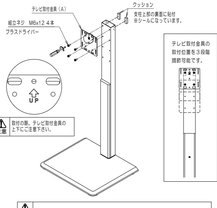
注意 テレビ取付金具取付時、ネジの締め付けは確実におこなってください。
