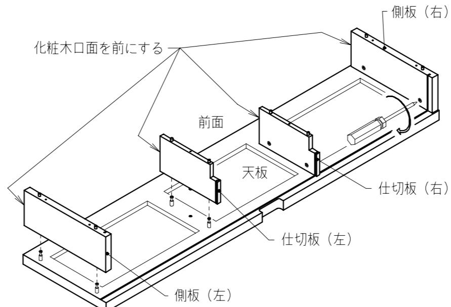
※ 天板に付けたシャフトに側板（左、右）、仕切板（左、右）を差し込み、ジョイント金具（カム）をしっかりと締め付けてください。
