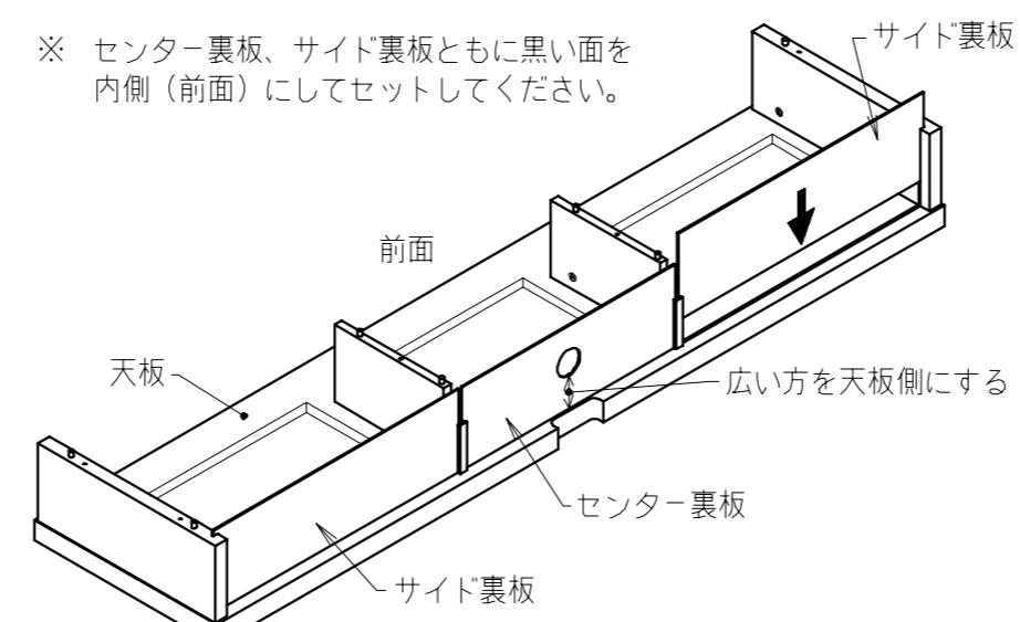
※ センターリー裏板、サイド裏板（2枚）の黒い面を内側（前面）にして、側板、仕切板の溝に差し込み天板の溝まで押し込んでください。
