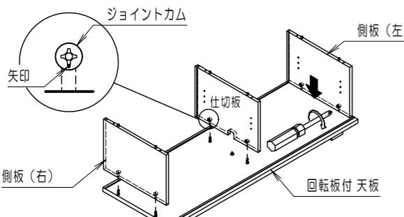
**注意** ジョイントカムの締め付けをする際、必ず90度から180度の範囲で締め付けてください。
