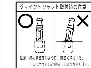
△ ジョイントカムの締め付けをする際、必ず90度から180度の範囲で締め付けてください。
