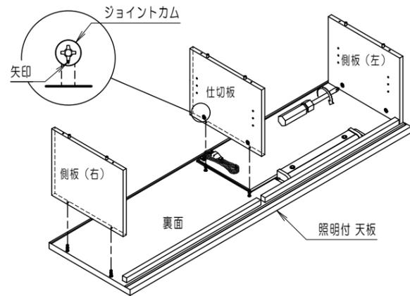
**5** 天板についているLED照明及び、地板のスイッチ付コンセントの配線を、右の図を参照のうえ接続してください。
