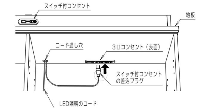
③ 余った配線は、束ねずに地板裏面についているコードクリップを使って上の配線図の様に固定してください。
