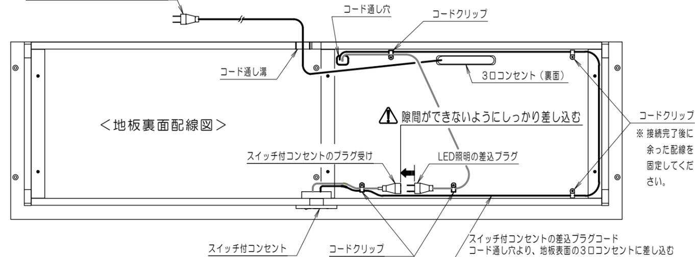
**警告** プラグの差込は隙間のないようしっかり差し込んでください。隙間があるとショートして火災の原因となります。
