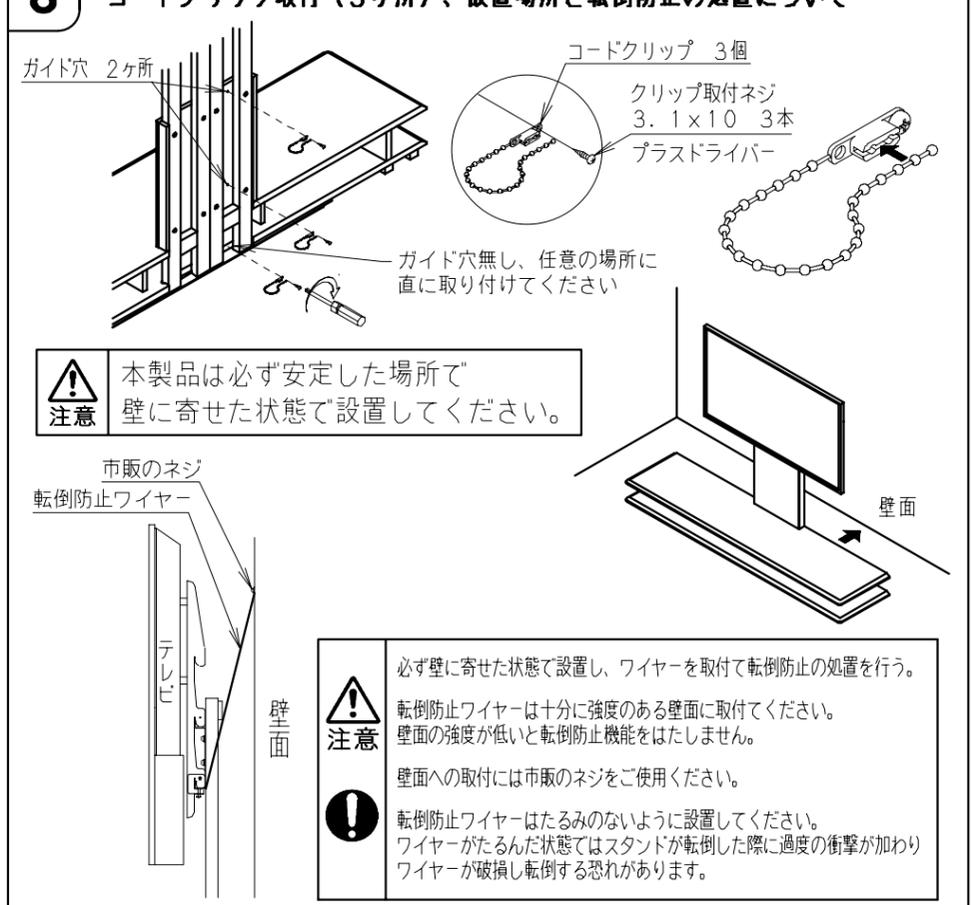
注意 ！ 本製品は必ず安定した場所で壁に寄せた状態で設置してください。
