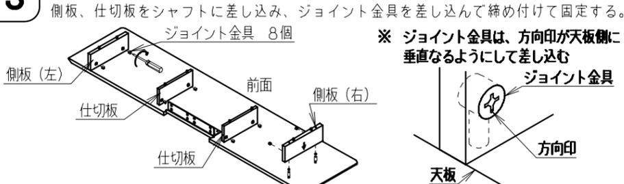
側板、仕切板をシャフトに差し込み、ジョイント金具を差し込んで締め付けて固定する。ジョイント金具 8個
