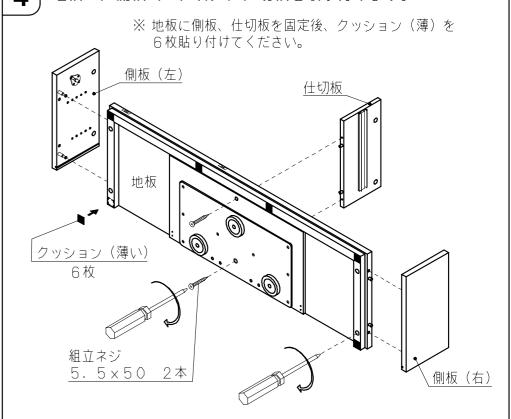
※ 側板に付けたシャフトを地板木口のシャフト差し込み穴に差し込み ジョイント金具(カム)をしっかりと締め付けてください、その後、 仕切板をセットして組立ネジ5.5×50にて固定してください
