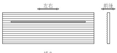
何き <u></u> ※ 左右、前後の調整 ト"ロップ丁番の ⊕ ネジをゆるめて 調整します、調整後はネジを締めて ください。
