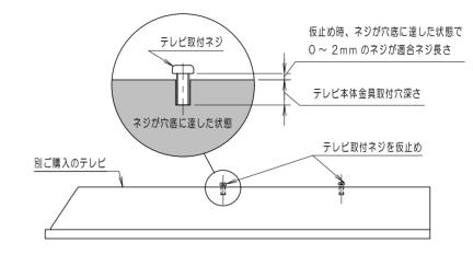
テレビ本体にネジを仮止めし、上図の寸法(O~2mm)に適合したネジをご使用ください。
