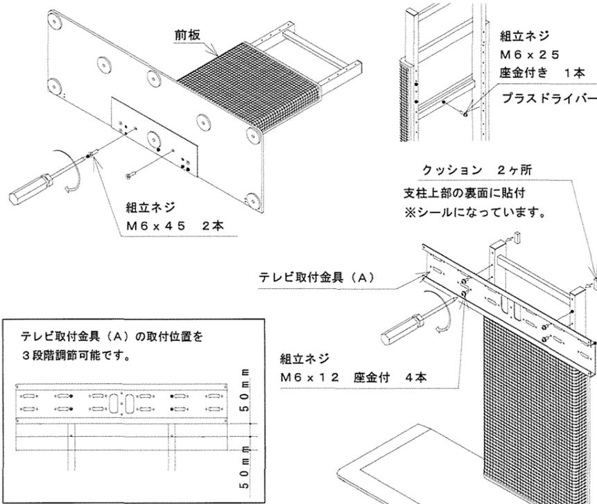
テレビ取付金具取付時、ネジの締め付けは確実にこなしてください。
