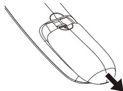
① 本体裏面の電池カバーを外します。
