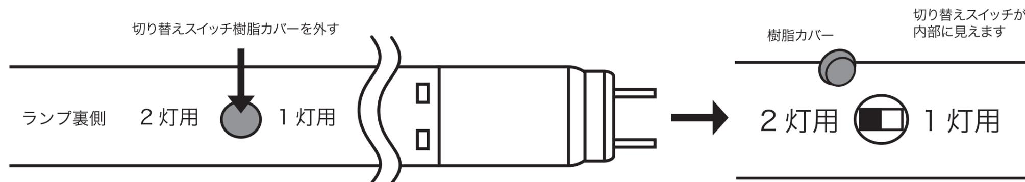
⑤ - 1 **1灯用**蛍光灯器具に装着する際は、ランプ内部にある切り替えスイッチを**1灯用**側に設定してください。
